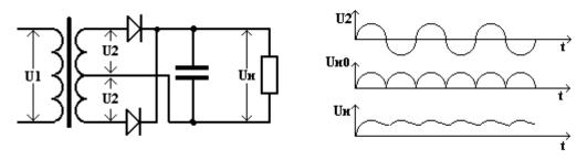
В этом выпрямителе используются два диода, имеющие общую нагрузку и две одинаковые вторичные обмотки трансформатора(или одну со средней точкой).
