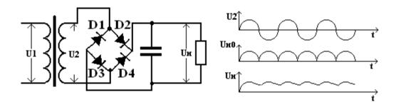
U2 – напряжение вторичной обмотки трансформатора, Uн0 – напряжение на нагрузке в отсутствие конденсатора, Uн – напряжение на нагрузке с применением фильтра.
