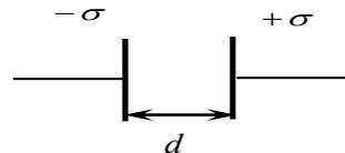
Емкость конденсатора, заполненного диэлектриком, больше емкости воздушного конденсатора в  $\varepsilon$  раз.
