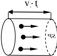
Внутри проводника мысленно построим цилиндр с площадью основания  $dS$  и высотой  $vt$ . За время  $t$  все заряды внутри цилиндра успевают пересечь площадку  $dS$ . Суммарный заряд, прошедший площадку  $dS$  за время  $t$  равен
