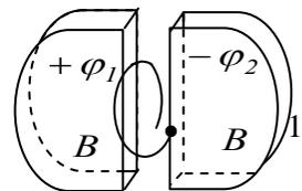
зазор частица движется по окружности под действием силы Лоренца. Величину магнитной индукции подбирают таким образом, чтобы период обращения частицы совпадал с периодом изменения напряжения на электродах. Тогда частица будет попадать в зазор между электродами при одной и той же фазе ускоряющего напряжения.
