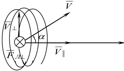
$\vec{V}_\tau$ , соответственно перпендикулярную и параллельную вектору индукции. При движении в направлении  $\vec{V}_n$  на частицу будет действовать сила Лоренца. Одновременно заряд будет двигаться по инерции в направлении  $\vec{V}_\tau$ . В результате сложения этих двух видов движения траектория движения
