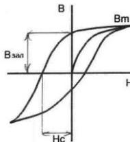
*Петля гистерезиса* - это зависимость  $B$  от  $H$ . При исчезновении внешнего поля  $H$  ферромагнетик остается намагниченным, что характеризуется *остаточной индукцией*  $B_{ост}$ . Чтобы его полностью размагнитить, нужно приложить поле противополож-
