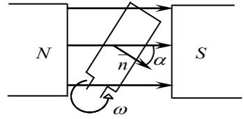
Предположим, что рамка вращается в однородном магнитном поле ( $\mathbf{B}=\text{const}$ ) равномерно с угловой скоростью  $\omega=\text{const}$ . Магнитный поток, сцепленный с рамкой площадью  $S$ , в любой момент времени  $t$  равен
