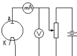
В отсутствие напряжения некоторые электроны совершают работу выхода из катода и образуют вокруг него электронное облако. В этом облаке электроны хаотически движутся и некоторые из них способны самопроизвольно долететь до анода. Эти электроны образуют небольшой ток при напряжении между катодом и анодом, равном нулю. Если увеличить напряжение, то все большее
